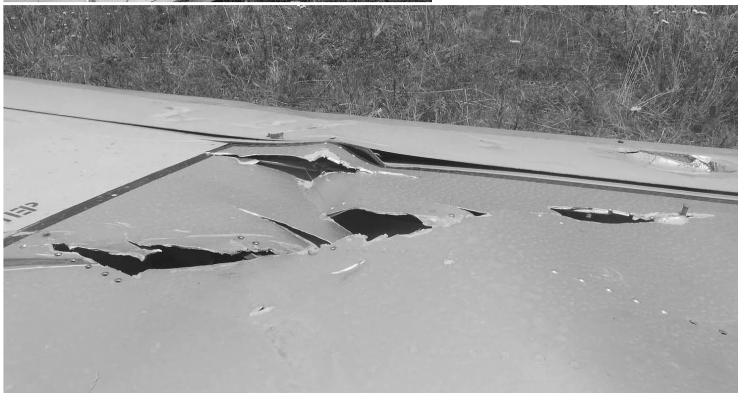
Фрагмент ТУ 154 пораженный осколочно-фугасной БЧ кольца — около 5 м. Поверх стержней уложен слой ГПЭ в форме кубиков массой 2-3 г Уточню. Име-
