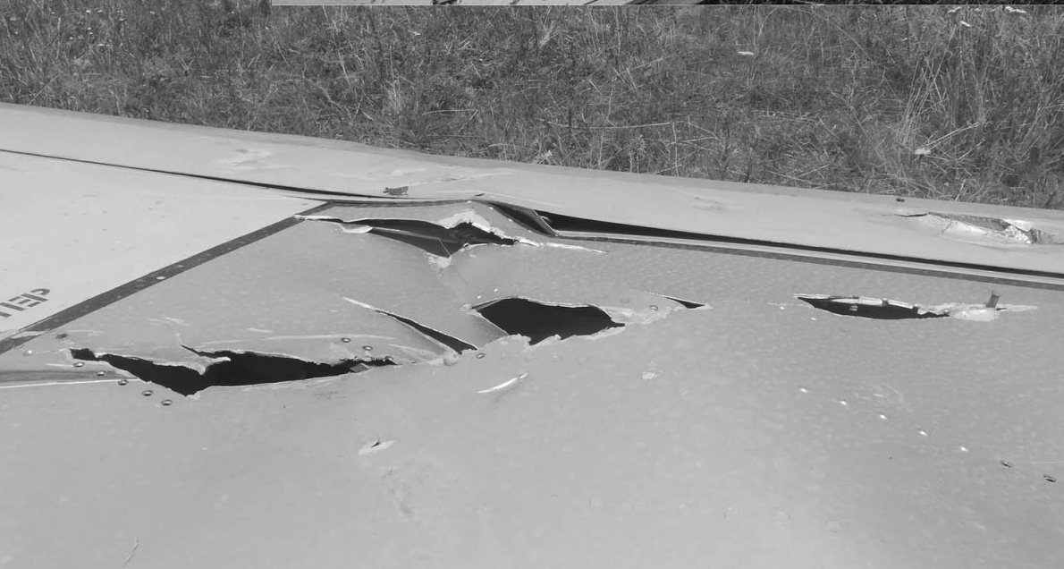
Порезы крыла Боинга, характерные для ракеты воздух-воздух
